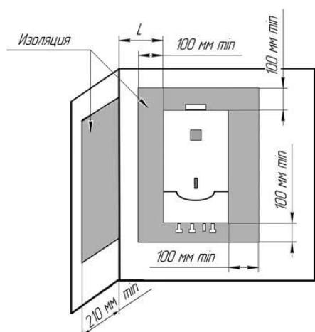
$L = 150 \text{ mm min}$  (расстояние до стены имеющей теплоизоляцию)
