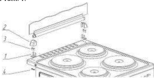
Рис. 6. Установка стеклянной крышки стола.
